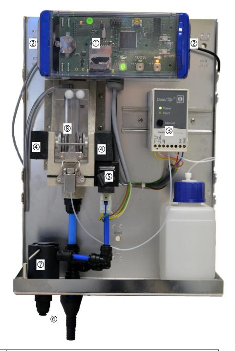
Placa controladora, motherboard com blocos de terminais para entradas e saídas está por trás 2 Ilhós passa-fios, de ambos os lados (3) Bomba de dosagem Unidade ótica (direita transmissor/esquerda recetor) 4 Bloco de válvulas (5) Ligações de água, entrada e saída 6 7 Entrada do regulador/filtro Câmara de medição 8
